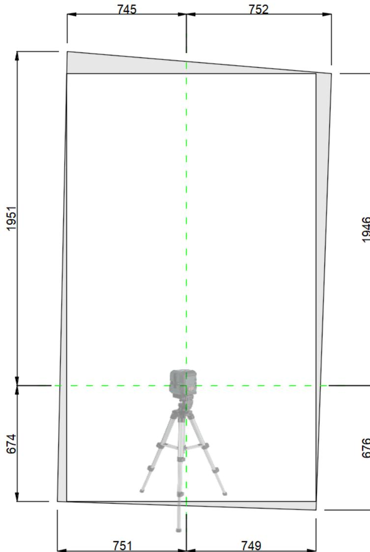
Mit einem Kreuzlinienlaser von den lotrechten Linien ausgehend die Maße abnehmen (wie oben dargestellt) damit man die Unebenheiten der Raumlichte erkennen und dementsprechend die Anlage planen kann!
